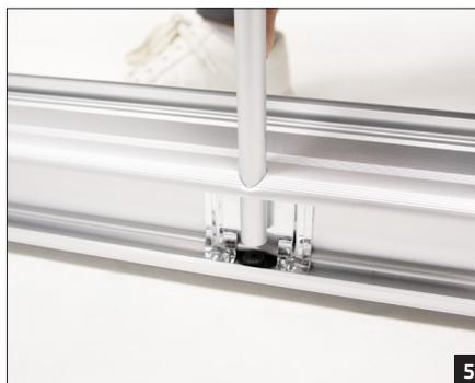
Stellen Sie sicher, dass die Stützstange in der unteren Einkerbung korrekt sitzt und fest verankert ist.
